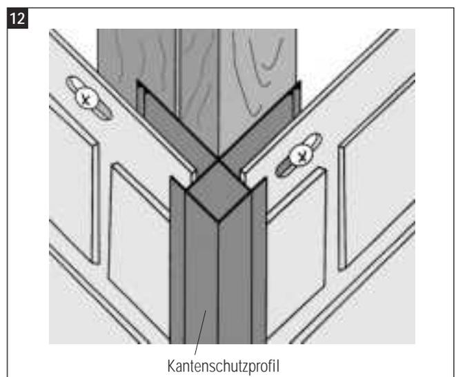
Bei Einschubprofilen ist ein imprägniertes Schaumstoffband auf der Rückseite hilfreich, welches die Fassadenelemente an die innere Vorderkante der Ecken drückt. Kleine sichtbare Abstände zwischen Ecke und Fassadenelement können mit dauerelastischem Kitt in Stein- bzw. fugengleichem Farbton ausgefugt werden. **10**
