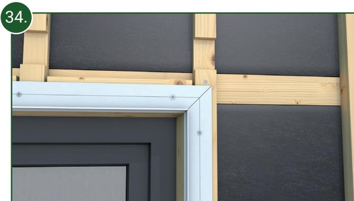
34. Montieren Sie die Unterteile der 2-teiligen Abschlussprofile bündig entlang der Fensterleibung. Die Eckverbindungen erfolgen per Gehrungsschnitt. Zur vollflächigen Auflage der Unterteile muss die Traglattung horizontal aufgefüttert werden.
