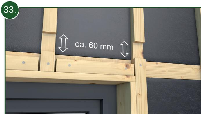
33. Klinken Sie die Traglattung oberhalb von Fenster- und Türelementen auf einer Länge von ca. 6 cm in einem Bereich aus, wo keine Verschraubung erfolgen muss. Somit wird eine ständige Luftzirkulation im Bereich oberhalb der Elemente sichergestellt (siehe Bild 42).
