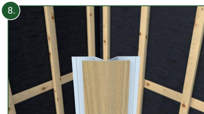
8. Verwenden Sie das variable Eckprofil (faltbar) zum Verschrauben in den Innenecken, sowie für Außenecken mit einem Winkel größer als 90 Grad.
