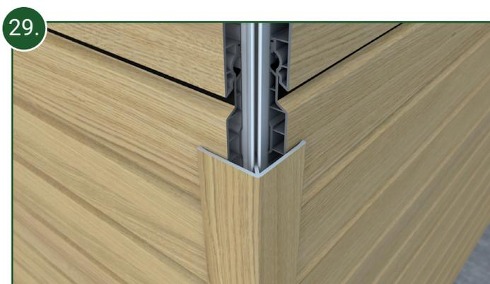
29. Die Oberteile des Eckprofils werden passend auf die exakt benötigte Länge zugesägt und anschließend auf die bereits montierten Unterteile aufgeklipst. Bitte berücksichtigen Sie bei der Länge der Oberteile eine mögliche Profilausdehnung von ca. 3 mm pro Meter! Die Schenkel sollen nach dem Zusammenfügen eng an den Fassadenprofilen anliegen.
