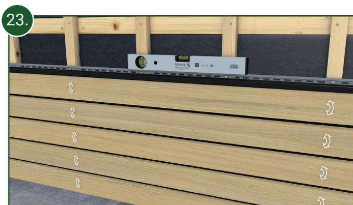
Die exakte Ausrichtung der Fassade sollte in regelmäßigen Abständen mit Hilfe einer Wasserwaage kontrolliert werden. Kleine Korrekturen sind jeweils beim Aufeinanderstapeln der Fassadenprofile möglich.
