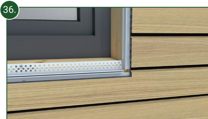
36. Klinken Sie Fassadenprofile in den Bereichen der Fensterleibungen am unteren und oberen Bereich der Fenster und Türen mit Hilfe einer Stichsäge aus.
