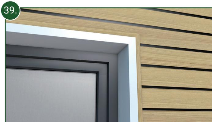
39. Die Fensterleibungen können bei Bedarf zusätzlich mit Dekodeck-Hartschaumwinkeln ausgekleidet werden. Sie können die Hartschaumwinkel vollflächig verkleben oder verschrauben.
