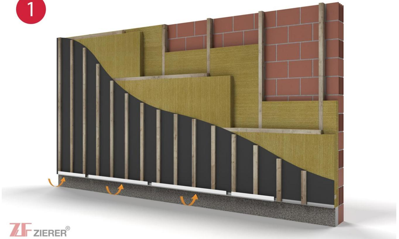
Die UK wird je nach Dämmstoffdicke aufgebaut. Mit der Konterlattung können unebene Wände ausgeglichen werden. Die vertikale Traglattung wird im Abstand von 25 cm erstellt, damit wird eine ungehinderte Be- und Entlüftung gewährleistet. Das Startprofil wird mit dem Lüftungsprofil ( untere Lüftung ) so an den Lattenenden angebracht, dass mindestens 3 cm Abstand zum Untergrund verbleiben.
