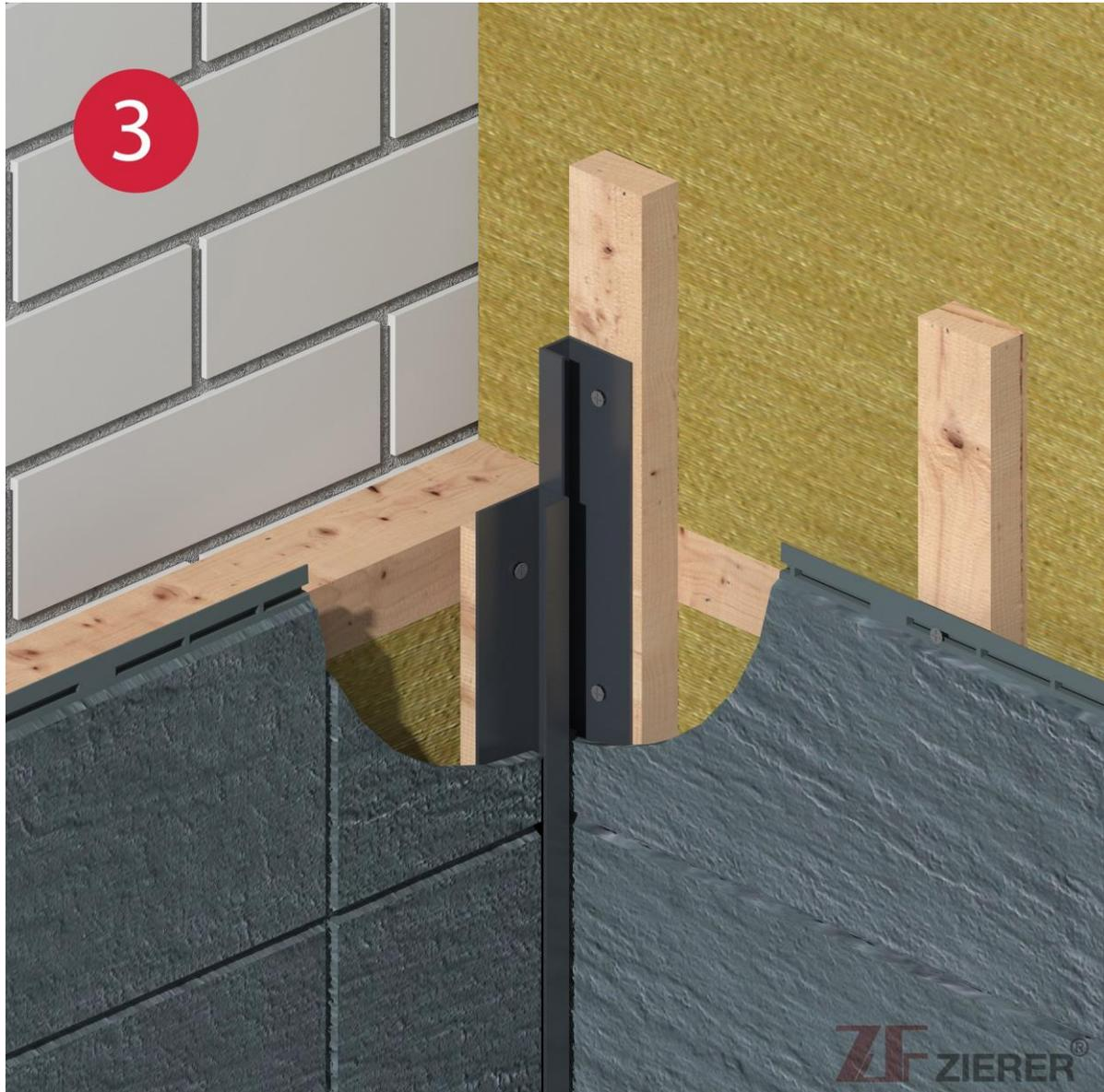
Das U-Profil wird im Bereich der Innenecke mit Einschub zu beiden Seiten verwendet
