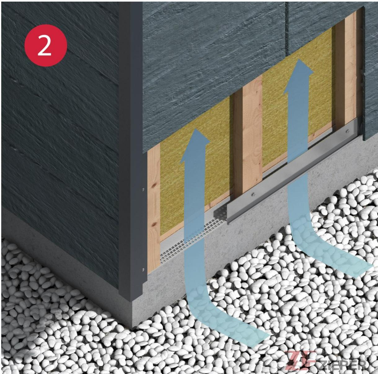
Die Starterleiste wird horizontal ausgerichtet und mit dem Lüftungsprofil ( Ungezieferschutz ) so an den Lattenenden befestigt, sodass ca. 3 cm Abstand ( Belüftung ) zum Untergrund bleibt. Die Verlegung erfolgt von links nach rechts, beginnend mit einem ganzen Element. Die Aussparung in der Starterleiste ist nicht zu berücksichtigen.
